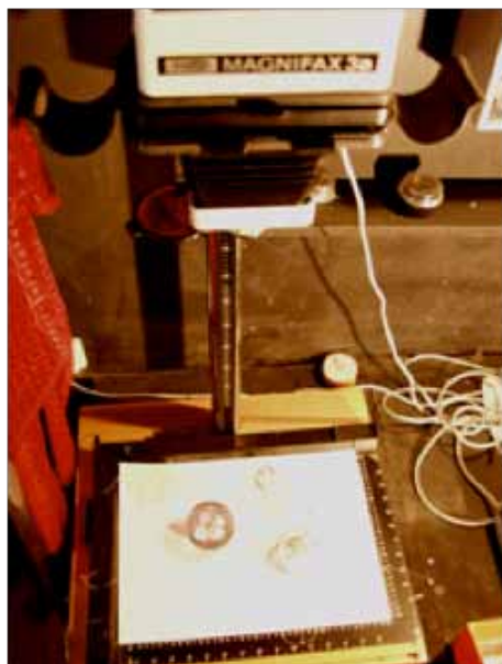
Čím větší je výtah na zvětšovacím přístroji, tím jsou předměty rovnoměrněji osvětleny
